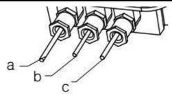
a : AC power cord (option : 3-core wire) b : Network cable above cat 5
